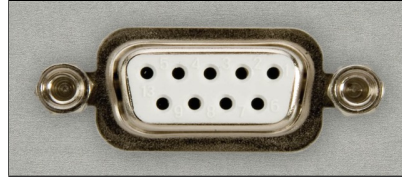
Abbildung 4.3: RS232-Anschluss an der Rück- oder Unterseite einer digitalen Waage
